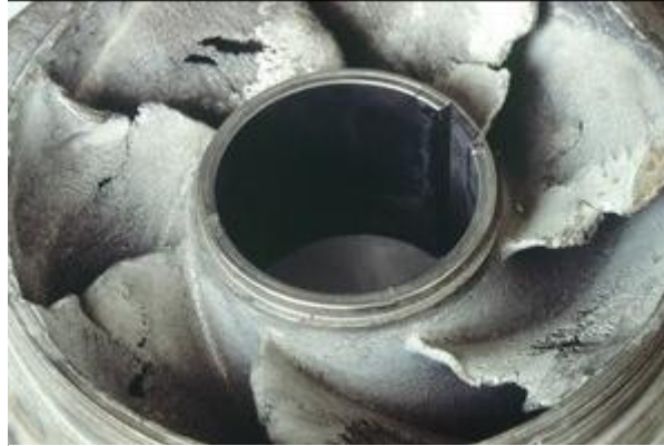
Figure 28: Roue attaquée par la cavitation
